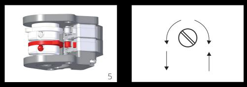
**5** Die Einstellung des Abschaltpunktes des unteren Notendschalters erfolgt mit der Einstellschraube der unteren Schaltnocke (rot).
